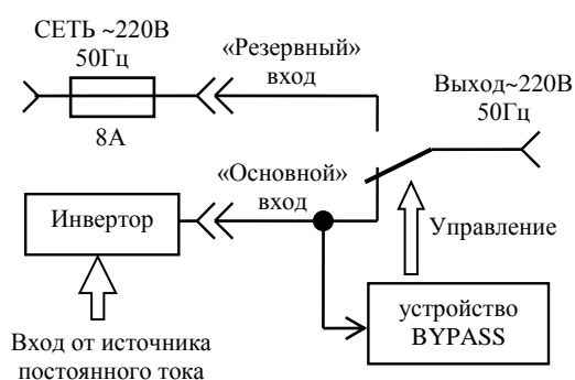
Рисунок 1.7- ON LINE («основной» источник - инвертор).
